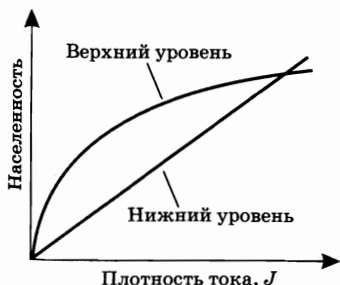
Рис. 10.3 Схематические зависимости населенностей верхнего и нижнего уровней He-Ne лазера от плотности электрического тока
