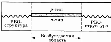
Рис. 9.32 Схематическое представление полупроводникового лазера с распределенным брэгговским отражением (РБО-лазер)
