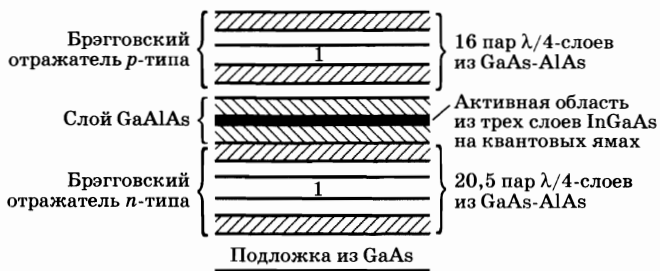
Рис. 9.34 Схематичное представление лазера с вертикальным резонатором и с нижней излучающей поверхностью. Самый верхний слой GaAs имеет толщину, равную половине длины волны, чтобы обеспечить согласование по фазе с металлическим контактом. (Согласно работе [52].)
